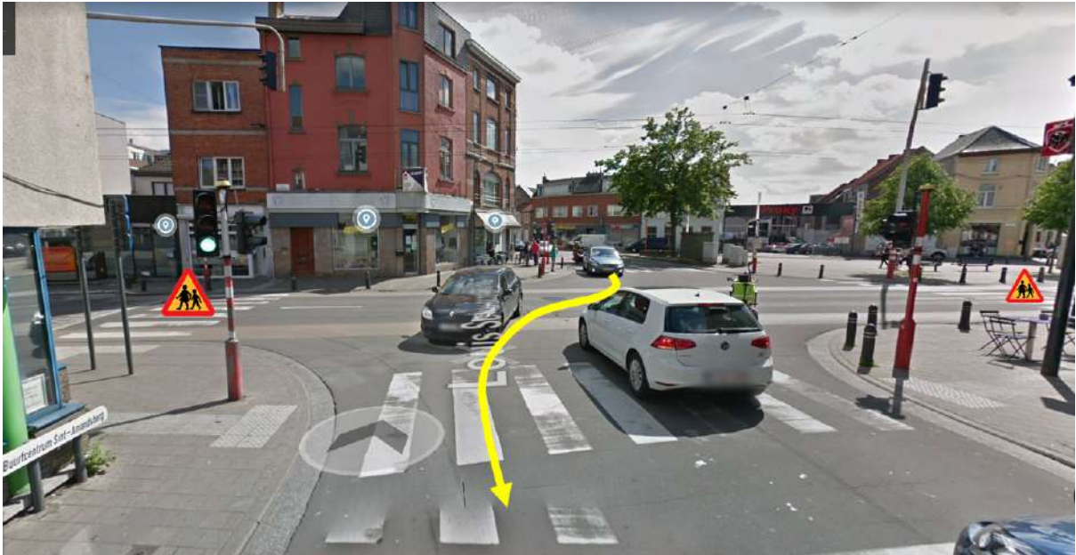
Zicht vanuit Schuurmansstraat: let op het S-vormig traject dat wagens afleggen over het kruispunt.
